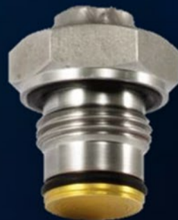
Abbildung 2 : H_2 -Teilchenstrom mit/ohne Goldbeschichtung & goldbeschichteter Anschluss
